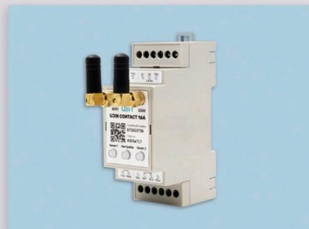
Это устройство для управления электрической нагрузкой. Коммутатор устанавливается на DIN-рейку в электрощитке и осуществляет управление одной или двумя линиями нагрузки. Также коммутатор Ujin Connect-din позволяет разделить линии нагрузки на отключаемые и не отключаемые. Это позволит выключать все розетки в доме, кроме, например, холодильника и роутера.
